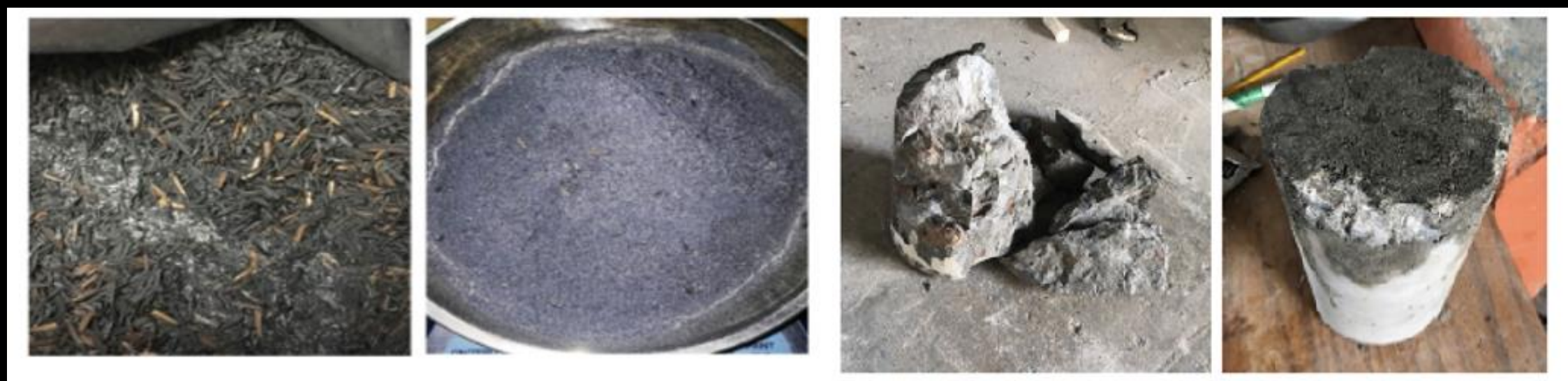
Figura 1. Resumen gráfico. Concreto con cenizas de cáscara de huevo y de cascarilla de arroz (Aizpurua & Caballero, 2018).
